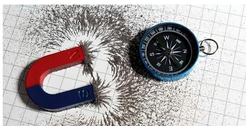
A bússola é composta por uma agulha magnetizada que se orienta conforme o magnetismo da Terra.
